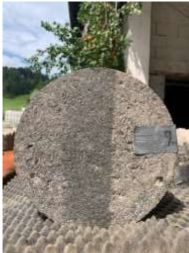
Bohrkernoberfläche 11 Jahre nach Herstellung
